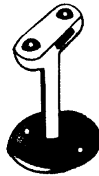
۵- بست تسمه مخصوص نصب روی خریا
