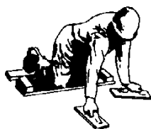
شکل ۶۱. ابزار و روشهای پرداخت سطح بتن ، روش پرداخت با تخته ماله
