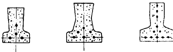
شکل ۷۸. قطبهای عرضی چند نوع تیرچه پیش تنیده
