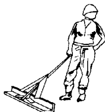
شکل ۶۰. ابزار و روشهای پرداخت سطح بتن ، شمشه کوچک
