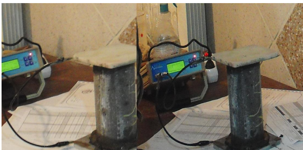
شکل (۲) چگونگی برقراری مدار و اندازه‌گیری مقاومت الکتریکی
