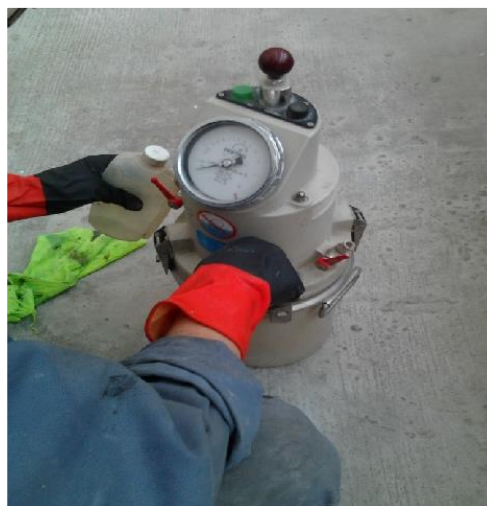
شکل ۴- آزمایش تعیین درصد هوای بتن تازه
