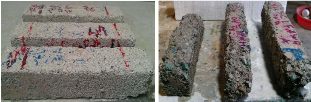
شکل ۳ نمونه ها پس از ۳۰۰ چرخه یخ زدن - آب شدن، تصویر راست: SCC-3-F و تصویر چپ: SCC-3-S
