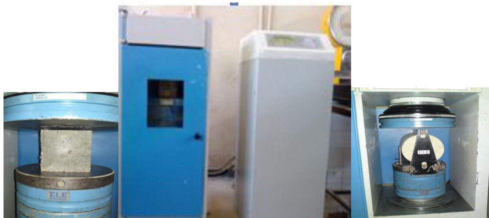
شکل (۵): دستگاه اندازه گیری مقاومت فشاری و کششی
