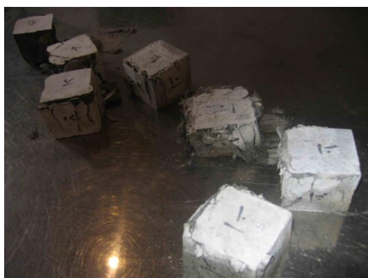
عکس شماره ۴ نمونه با الیاف شیشه
