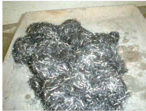
عکس شماره ۱ توده از الیاف فولادی
