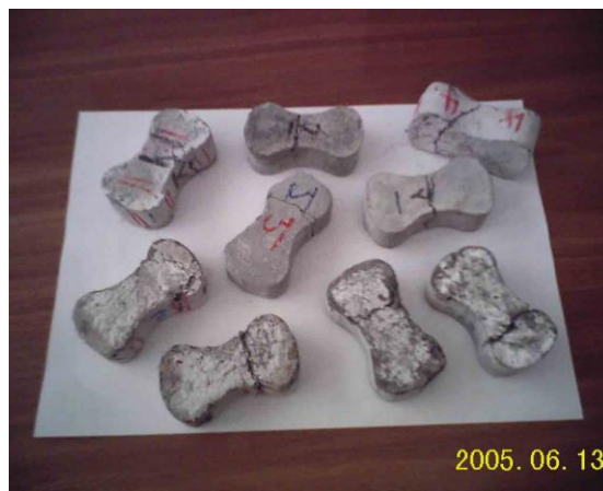
عکس شماره ۷ نمونه کششی شکسته شده حاوی الیاف
