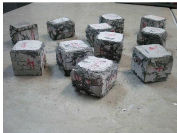
عکس شماره ۳ نمونه های شکسته شده با الیاف فولادی
