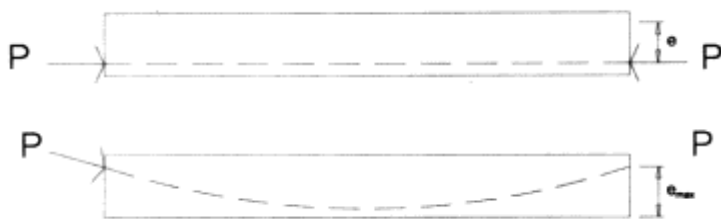
شکل ۱۳-۵: جای گیری آرماتورهای پیش تنیدگی در تیر ساده
