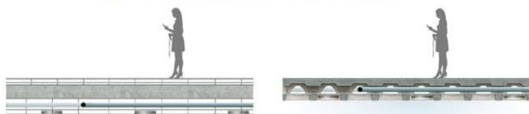
کاهش ضخامت سقف با حذف سقف کاذب و عبور تاسیسات از داخل سقف
