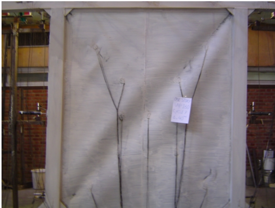
شکل (۳): کمانش ورق در سیکل هجدهم
