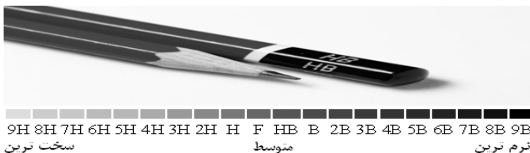
شکل 1-2. شکل مداد و نمادهای سختی آن
