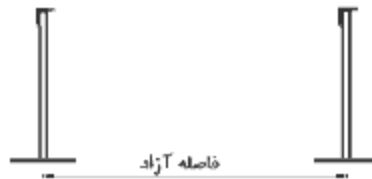
شکل ۸-۲- فاصله‌ی آزاد بین تیرچه‌های فولادی
