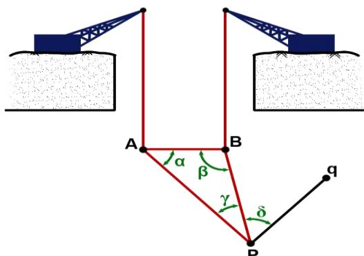
$$G_{AB} = 80^\circ 13' 15'' \quad \gamma = 25^\circ 11' 5''$$
