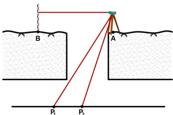
منشورهایی وجود دارند که در جلو تلسکوپ دوربین نصب می‌شوند و راستای محور دیدگانی را  $90^\circ$  به سمت زنیت تغییر می‌دهند. در این روش مانند شکل بعد از توجیه دوربین نسبت به امتداد  $AB$  به  $B$  منشور گونیاساز را نصب کرده و دو نقطه  $P_1$  و  $P_2$  را با زاویه مدنظر نسبت به امتداد  $AB$  پیاده سازی می‌کنیم.
