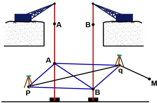
در این روش نیز همانند شکل از دو شاقول آویزان در سطح روغن جهت جلوگیری از نوسانات شاقول استفاده می‌شود و مختصات نقاط A و B توسط ایستگاه‌های کنترل زمینی مشخص می‌شود. حال با انجام مشاهداتی از دو نقطه امتدادی که از میان دو نقطه A و B می‌گذارد اقدام به محاسبه وضعیت امتداد مستقر شده (امتداد pq) می‌نماییم.
