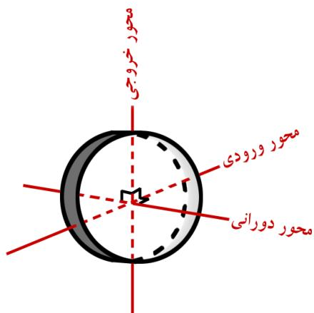
ژیروسکوپ: وسیله‌ای است که نسبت به سیستم مختصات اینترشیا تمایل به حفظ توجیه خود را دارد. اساس کار این وسیله از یک جسم دوران کننده (یک دیسک یا گوی با تعداد دوران ۲۰ الی ۲۵ هزار دور در دقیقه) حول یک محور می‌باشد که تحت تأثیر نیروی خارجی حاصل از دوران زمین (نیروی گریز از مرکز) قرار دارد و باعث می‌شود که محور دورانی در راستای شمال قرار گیرد.
