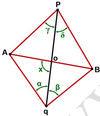
**مثال:** جهت تعیین ژیزمان امتداد زیزمنی  $pq$  از دو شاقول آویزان در نقاط  $B$  و  $A$  با مختصات های زیر استفاده شده و سپس در زیر زمین از روی دو نقطه  $p$  و  $q$  مشاهدات زیر انجام شده است مطلوب است ژیزمان امتداد  $pq$ .
