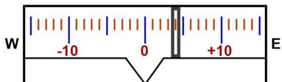
محل قرار گیرد که جهت این کار از یک قطب نما استفاده می کنیم. چنانچه به چشمی قرائت نوسان نگاه کنید شکلی مشابه شکل روبرو را خواهید دید. حال برای شروع کار پیج آلیداد را باز کرده و ژیروسکوپ را روشن کنید
