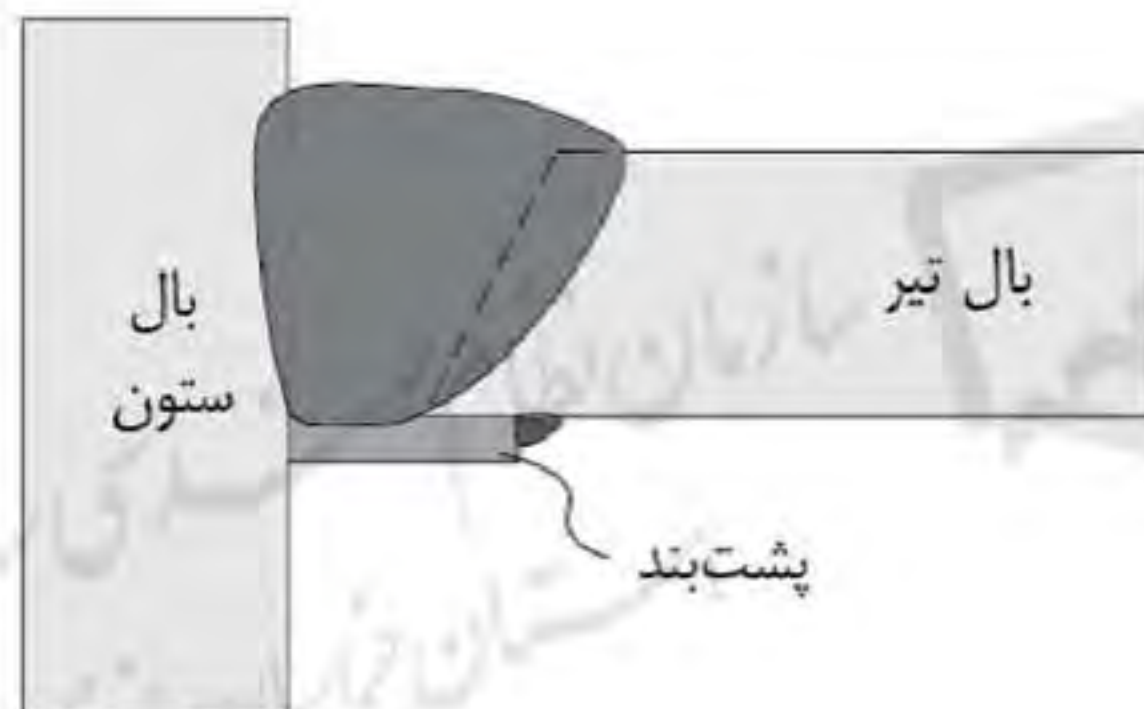
شکل ر-۳-۷ اتصال نادرست پشت‌بند به بال تیر
