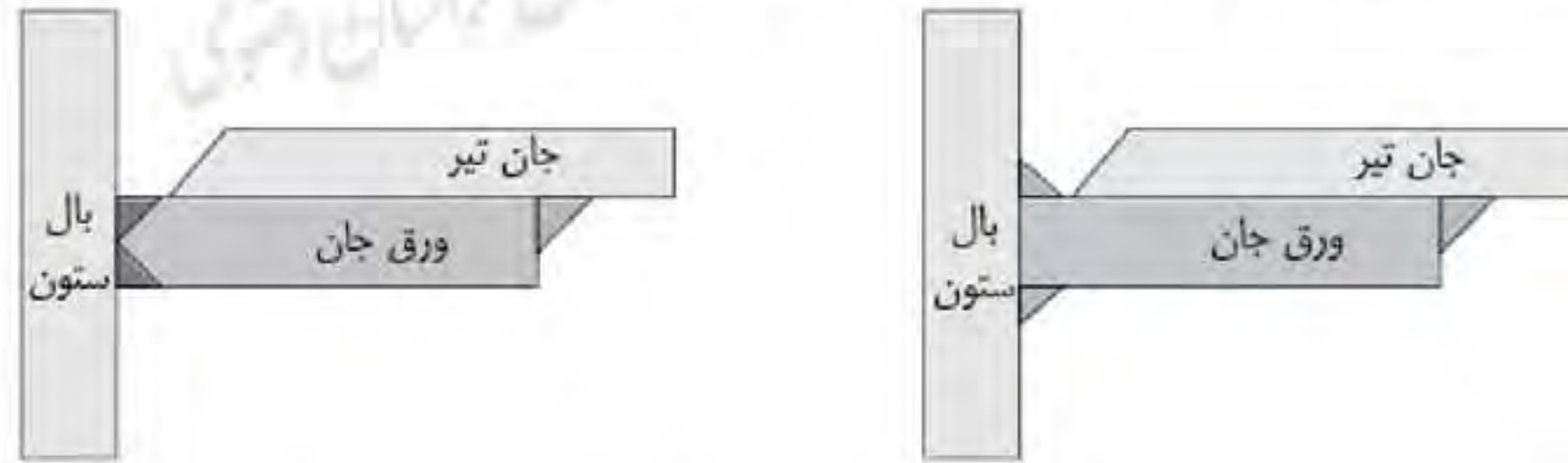
شکل ۸-۱۱ عقب‌نشینی جان تیر نسبت به بال ستون در جوش‌های شیاری و گوشه
