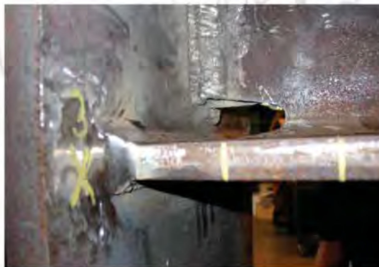
شکل ر-۳-۱۲ بال پایینی تیر پس از حذف ناودانی انتهایی جوش
