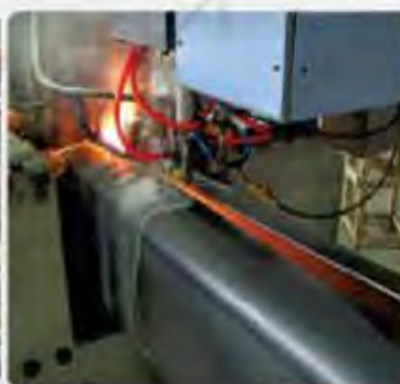
خط تولید توپول‌های HSS در کارخانه فولاد ماشین تک
