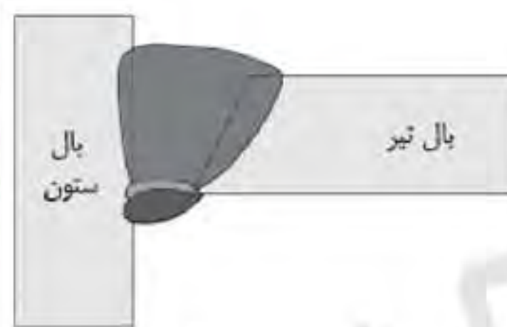
شکل ر-۳-۴ اصلاح ریشه‌ی جوش شیاری بال پایینی، روش اول
