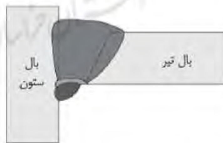
شکل ر-۳-۵ اصلاح ریشه‌ی جوش شیاری بال پایینی، روش دوم
