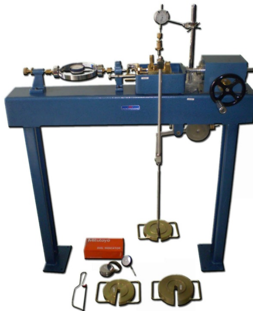
شکل ۸-۶ دستگاه آزمایش برش مستقیم با کنترل کرنش
