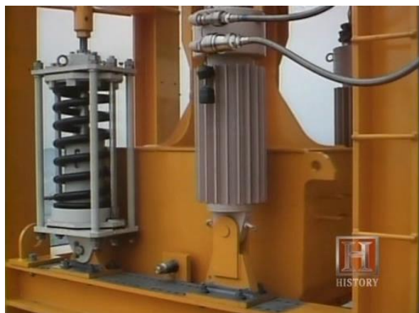
شکل ( ۲-۵۸): استفاده از میراگر پاندولی در پایه ها جهت کاهش
