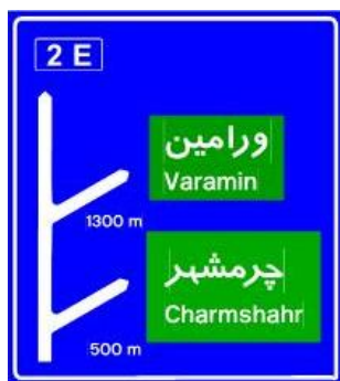
شکل ۸۳- نمونه تابلوهای اطلاعاتی پیش آگاهی کناری برای تقاطع های دو خروجی نزدیک به هم
