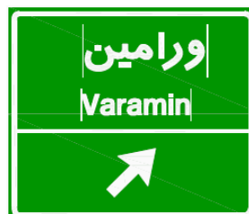
شکل ۷۹- نمونه تابلوی اطلاعاتی بالاسری در محل برای تقاطع های دو خروجی نزدیک به هم
