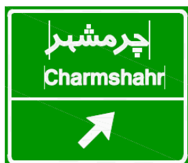
شکل ۷۹- نمونه تابلوی اطلاعاتی بالاسری در محل برای تقاطع های دو خروجی نزدیک به هم
