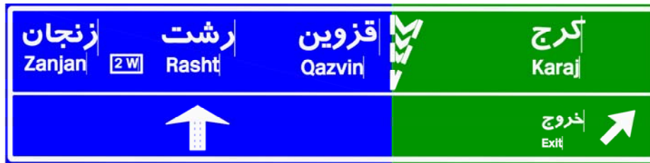
شکل ۱۱- نمونه تابلوی اطلاعاتی بالاسری در محل برای خروجی دارای خط کاهش سرعت
