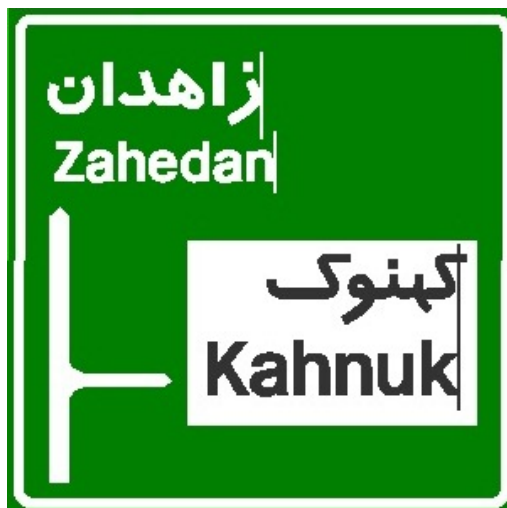
شکل ۷- نمونه ای از تابلوهای اطلاعاتی در راه اصلی
