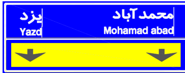
شکل ۳۴- نمونه تابلوی اطلاعاتی بالاسری در دماغه خروجی در تقاطع های دارای خروجی تخصیص یافته در سمت راست
