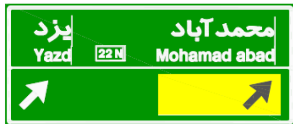
شکل ۳۵- نمونه تابلوی اطلاعاتی بالاسری در دماغه خروجی در تقاطع های دارای خروجی تخصیص یافته در سمت راست
