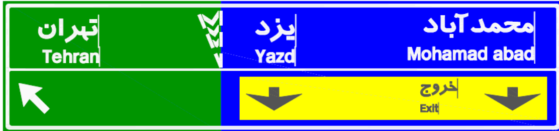
شکل ۳۳- نمونه تابلوهای اطلاعاتی بالاسری در محل در تقاطع های دارای خروجی تخصیص یافته در سمت راست
