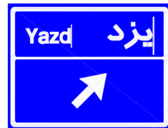
شکل ۶۵-نمونه تابلوی اطلاعاتی بالاسری در دماغه خروجی در تقاطع های پایان مسیر و تفکیک آن به دو مسیر جدا از هم
