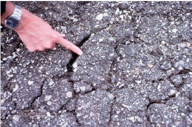
شکل ۴- ترک‌خوردگی پوست سوسماری
