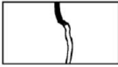
الف- پر کردن همسطح (fill)
