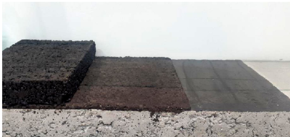
بکارگیری میکروسورفیسینگ و اسلاری سیل به عنوان یک لایه آب بند
