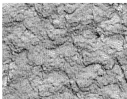
شکل ۱: نیمرخ نمونه به مقدار 7 \pm میلی متر (گرفته شده از راهنمای شماره ۳۷۳۲ - موسسه ICRI - نیمرخ شماره ۷). این نیمرخ مقدار استاندارد توصیه شده در روش بتن پاشی با فشار کم است.
