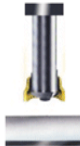
نزدیک شدن گلمیخ با ورق
