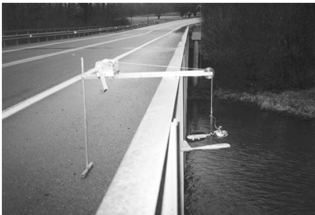
تصویر ۲۰- اندازه گیری مقدار هواکش از روی عرشه پل
