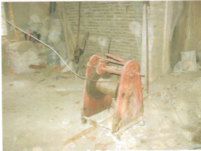
دستگاه وینچ برای بلند کردن ستونها به صورت دستی
