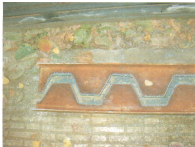
نحوه برشکاری تیر IPE برای تبدیل به تیر لانه زنبوری
