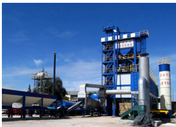
تصویر از کارخانه آسفالت برای ساخت آسفالت.
