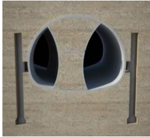
الف- حفاری دریف‌های کناری و حفاری شمع‌ها
