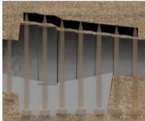
پ- حفاری گالری فوقانی (نمای جانبی)
