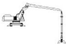
پ- سیستم تخلیه خاک با استفاده از بیل مکانیکی با بازوی تلسکوپی
