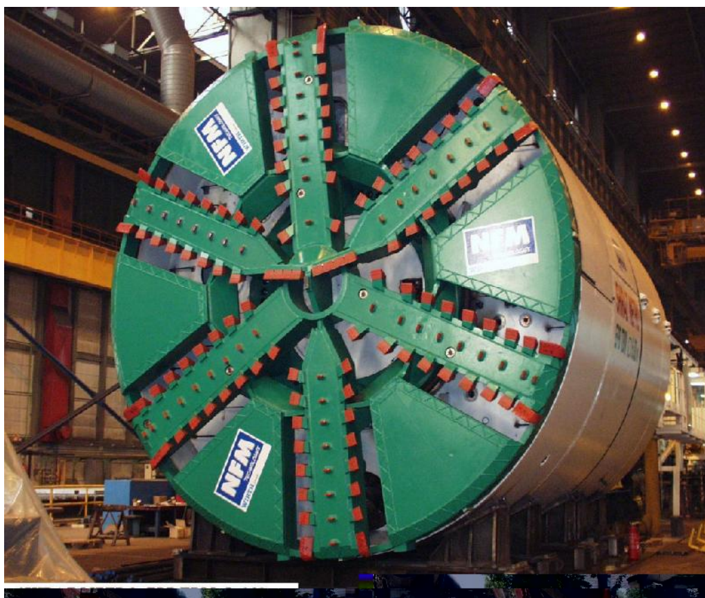
شکل ۱۵- دستگاه حفاری ماشینی تمام مقطع مترو شیراز
