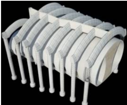
ج- مقطع مسلح شده و آماده حفاری بخش میانی
