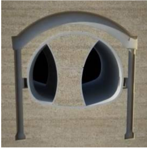
ب- حفاری ریب‌های فوقانی مقطع
