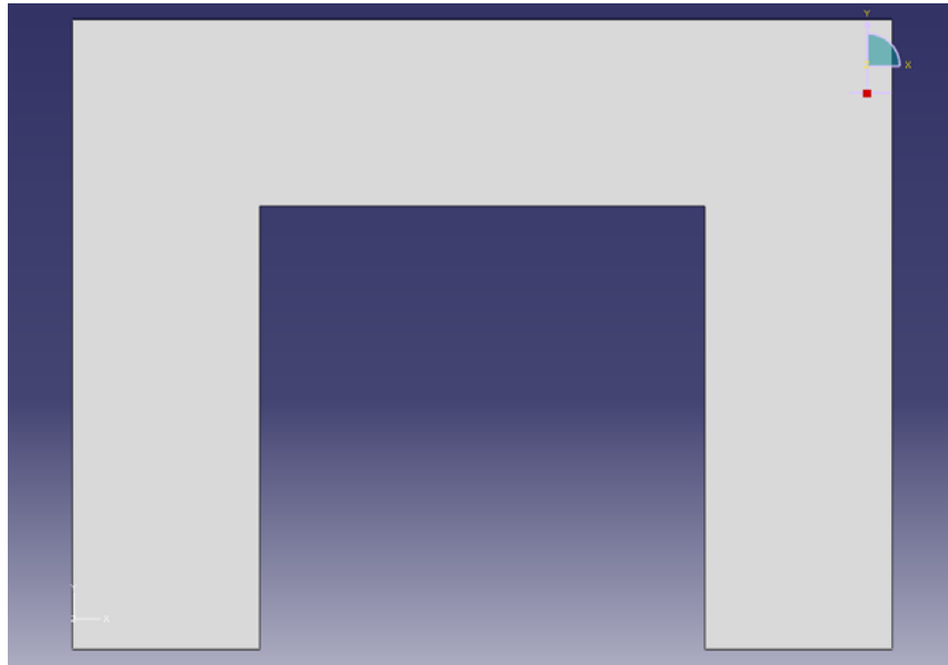
شکل ۸-۸- سخت کننده تیر ساخته شده
