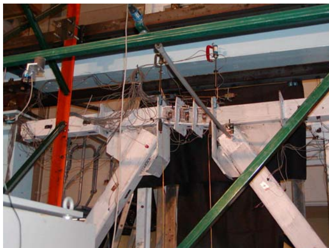
شکل ۸-۲- مدل آزمایشگاهی قاب مهارشده واگرا
