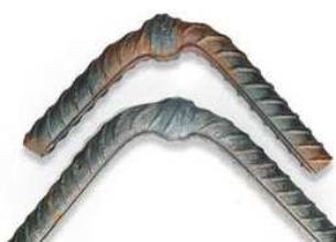
نمونه آزمایش خمش
