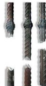
نمونه آزمایش کشش
